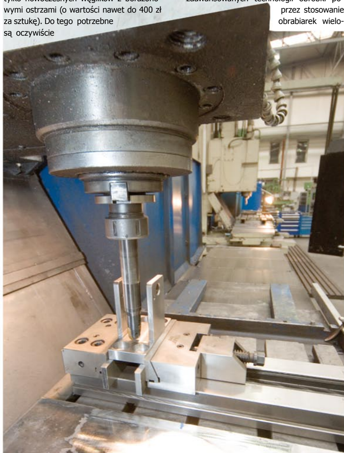
Frezowanie „wysokich uszu” w materiale o twardości 40 HRC długim narzędziem z wbudowanym zespołem redukcji drgań
