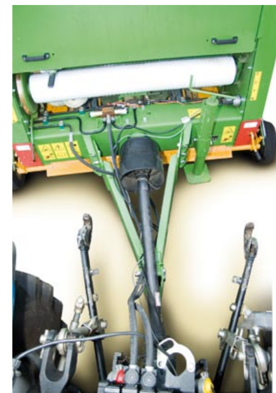
Połączenie prasy belującej Z 500 z ciągnikiem poprzez wał przegubowy szerokokątny ze sprzęgłem przeciążeniowym
