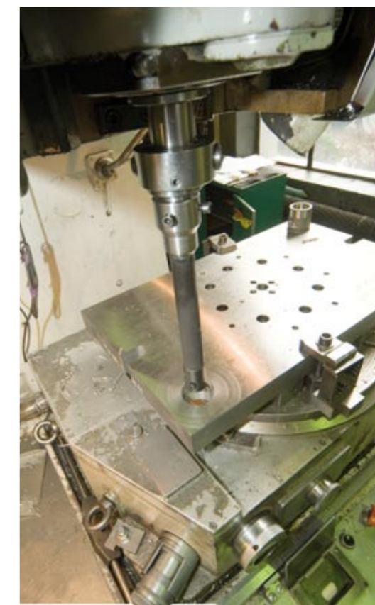
Wytaczanie długich i dokładnych otworów (~0,01 mm) specjalnym narzędziem z redukcją drgań
