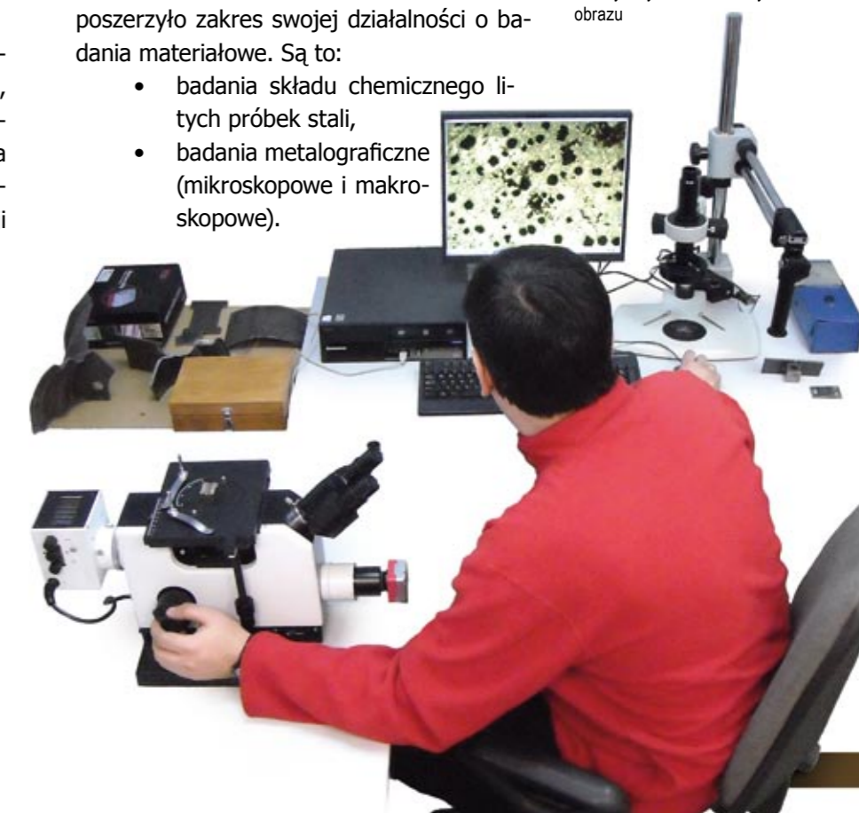
Stanowisko do badań makro- i mikroskopowych z komputerowym systemem analizy obrazu
