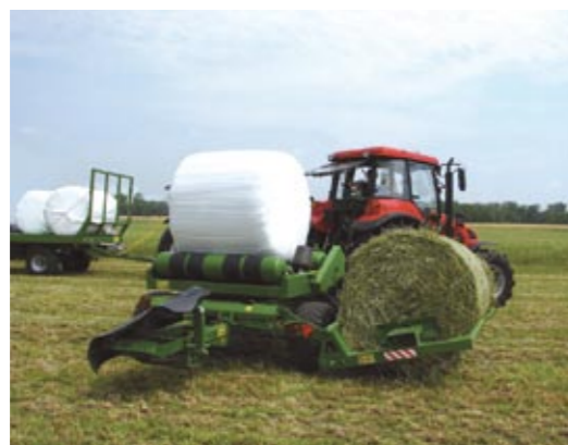
Owijarka ciągniona Z245 pozwala na jednoczesne owijanie balotu i załadunek kolejnego
