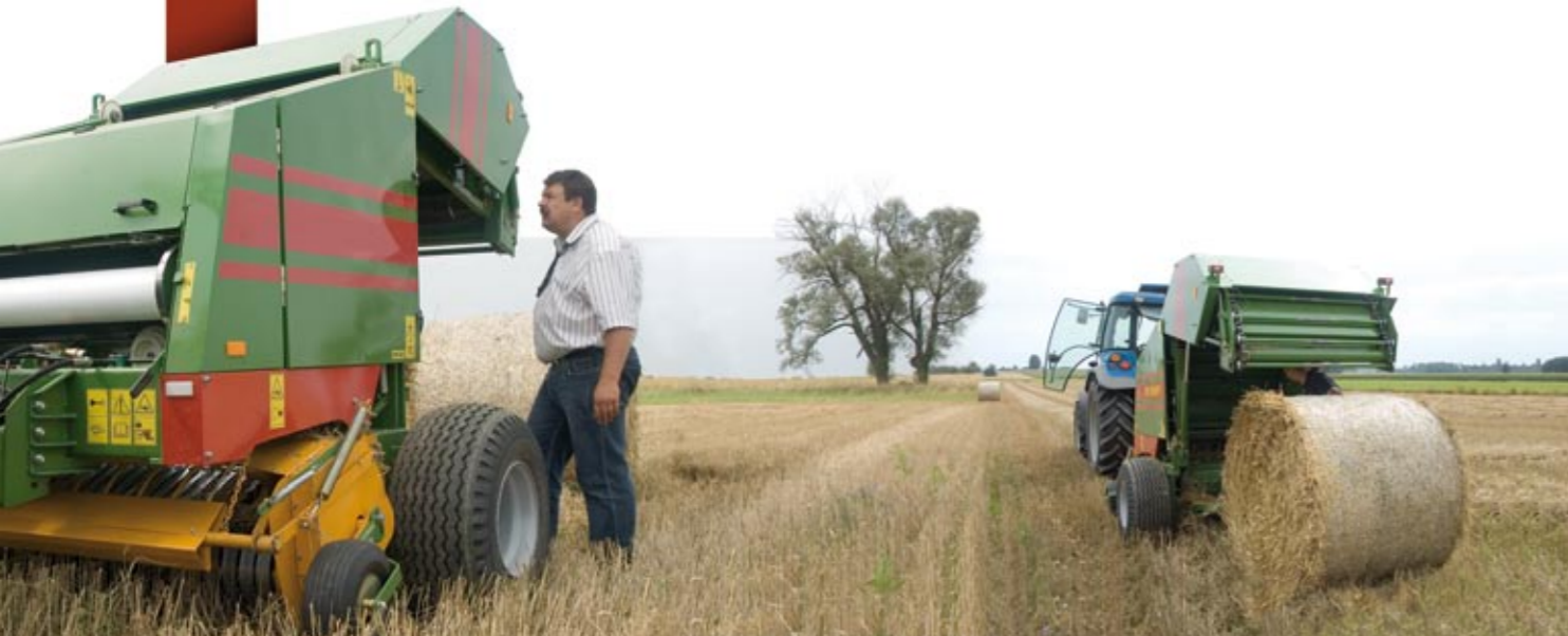
Prasa belująca Z500 - zbiór słomy prz użyciu obwiązywa- cza siatką
