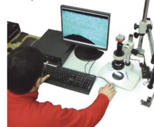
Badanie makroskopowe uszkodzonego elementu pierścienia
