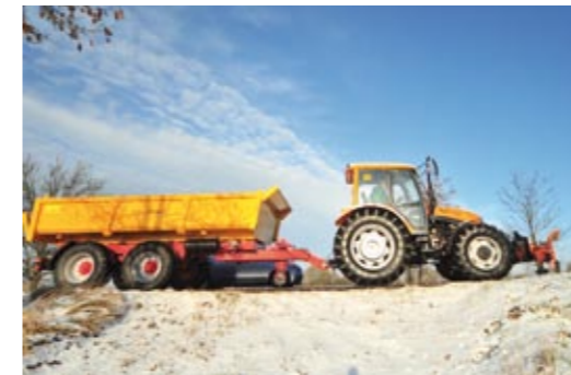
Sprzęt jest testowany w różnych warunkach pogodowych. Na zdjęciu: 85-konny Zefir w wersji komunalnej z przyczepą budowlaną T679/2 podczas prób zimowych
