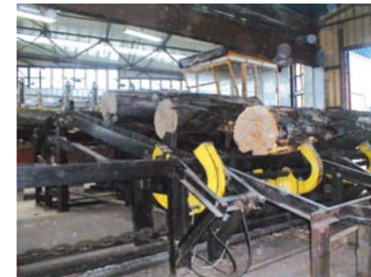
Surowiec (okraglak) na podajniku do traka taśmowego
