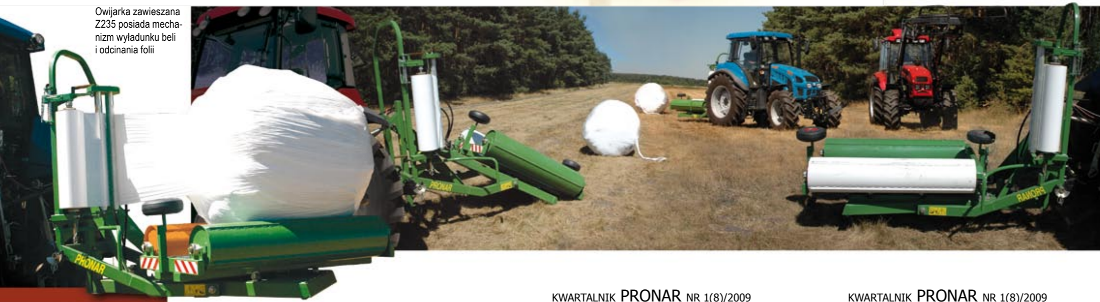
Owijarka Z245 (podobnie jak Z235) może owijać zarówno folią o szerokości 500, jak i 750 mm
