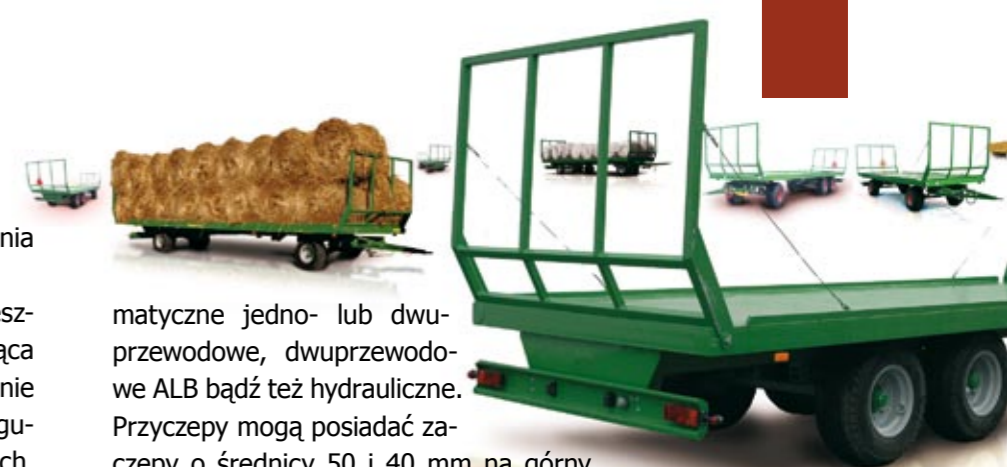
Uchyłne ściany w przyczepach platformowych zabezpieczają ładunek podczas jazdy, oraz pozwalają na załadunek większej liczby balotów
